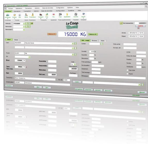
La fenêtre principale possède toutes les fonctionnalités vous permettant de générer rapidement les billets de pesée et ainsi réduire au minimum le temps d'attente des camionneurs.
