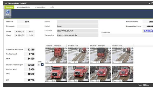
La fenêtre de transaction permet de visualiser l'ensemble des informations relatives à une pesée. Une fonctionnalité offre la possibilité d'effectuer un zoom sur toute photo associée à la pesée afin de voir de façon précise l'identification du véhicule ainsi que son positionnement sur la balance.
